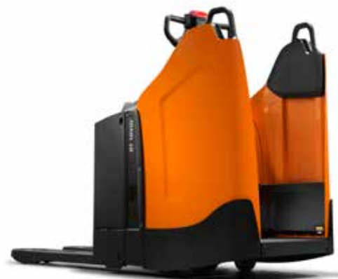
Disponibili, in opzione, le protezioni laterali fisse e la pedana fissa.
