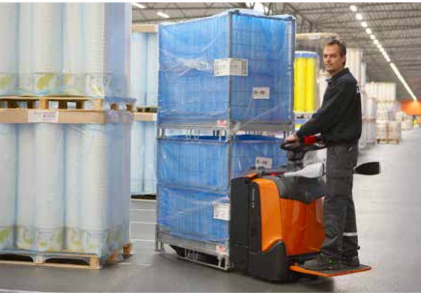
I modelli standard hanno la pedana e le protezioni laterali richiudibili.
