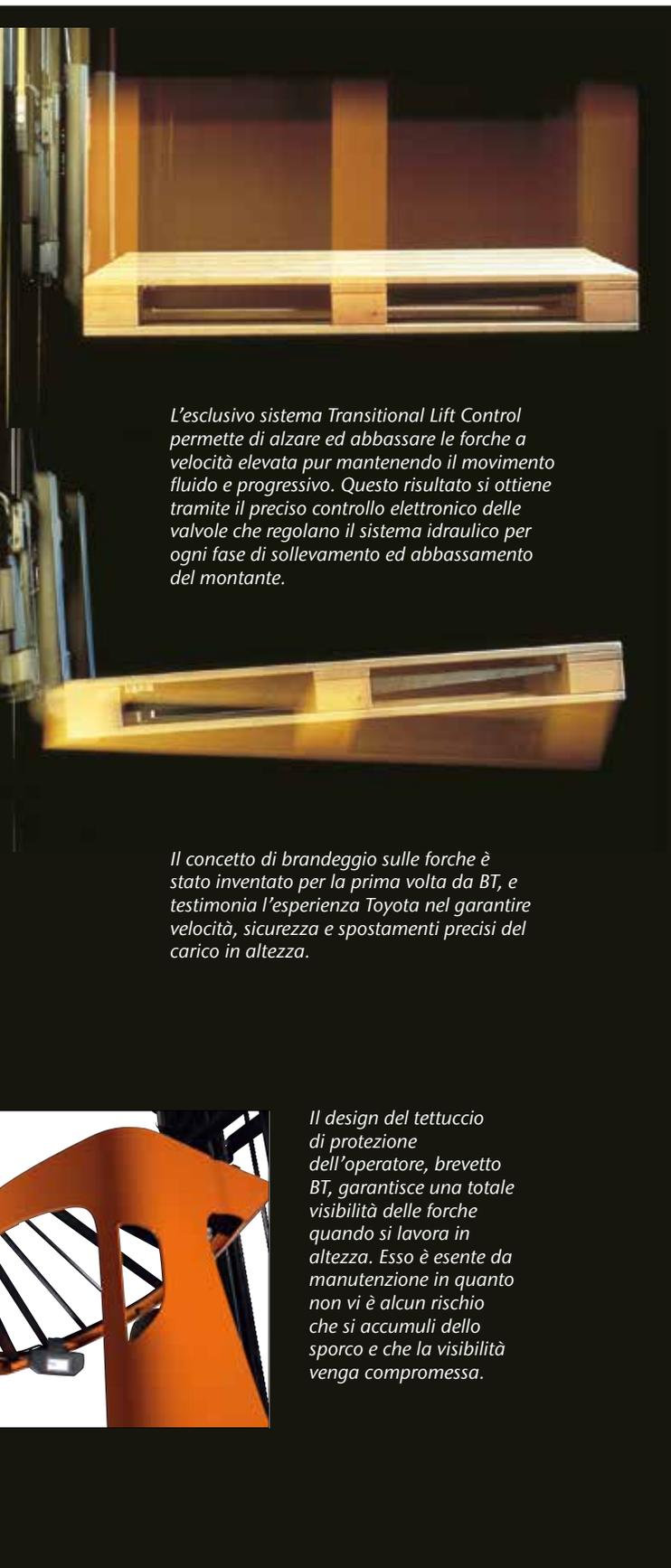
*L'esclusivo sistema Transitional Lift Control permette di alzare ed abbassare le forche a velocità elevata pur mantenendo il movimento fluido e progressivo. Questo risultato si ottiene tramite il preciso controllo elettronico delle valvole che regolano il sistema idraulico per ogni fase di sollevamento ed abbassamento del montante.*
