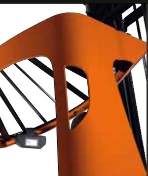
*Il design del tettuccio di protezione dell'operatore, brevetto BT, garantisce una totale visibilità delle forche quando si lavora in altezza. Esso è esente da manutenzione in quanto non vi è alcun rischio che si accumuli dello sporco e che la visibilità venga compromessa.*
